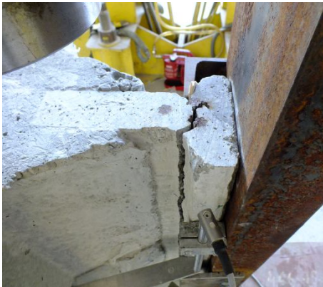
Fot.5 Zerstörung des Balkens L3.
