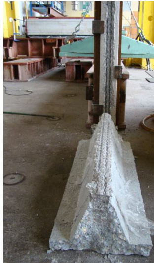
Fot.6 Zerstörung des Balkens L2.
